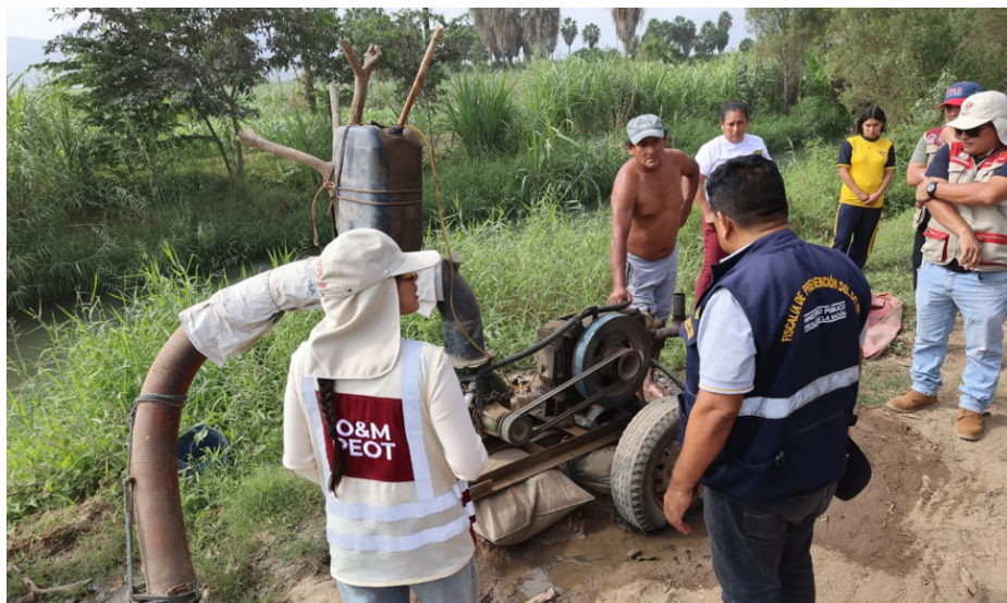
MOTOBOMBA CON TUBERÍA FUE HALLADA SUSTRAYENDO ILEGALMENTE AGUA DE CANAL.
